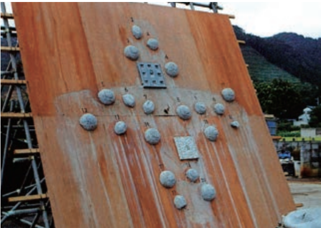
人工斜面の凹凸状況
