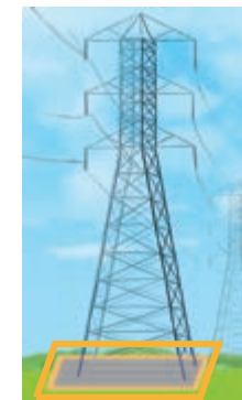
送電塔周辺の浸食部
