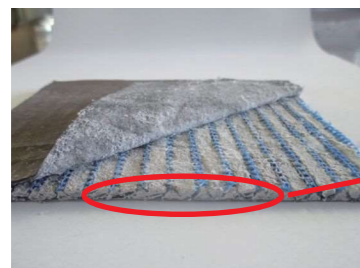
硬化後の内部状況
